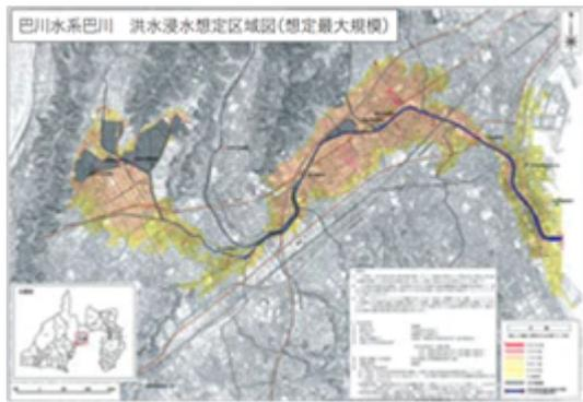
激甚化する洪水対策として、現在の河川の洪水調節能力に基づいて、想定最大規模の降雨が生じた場合の浸水エリアや浸水継続時間を想定したマップ事例（静岡県、2017年）
