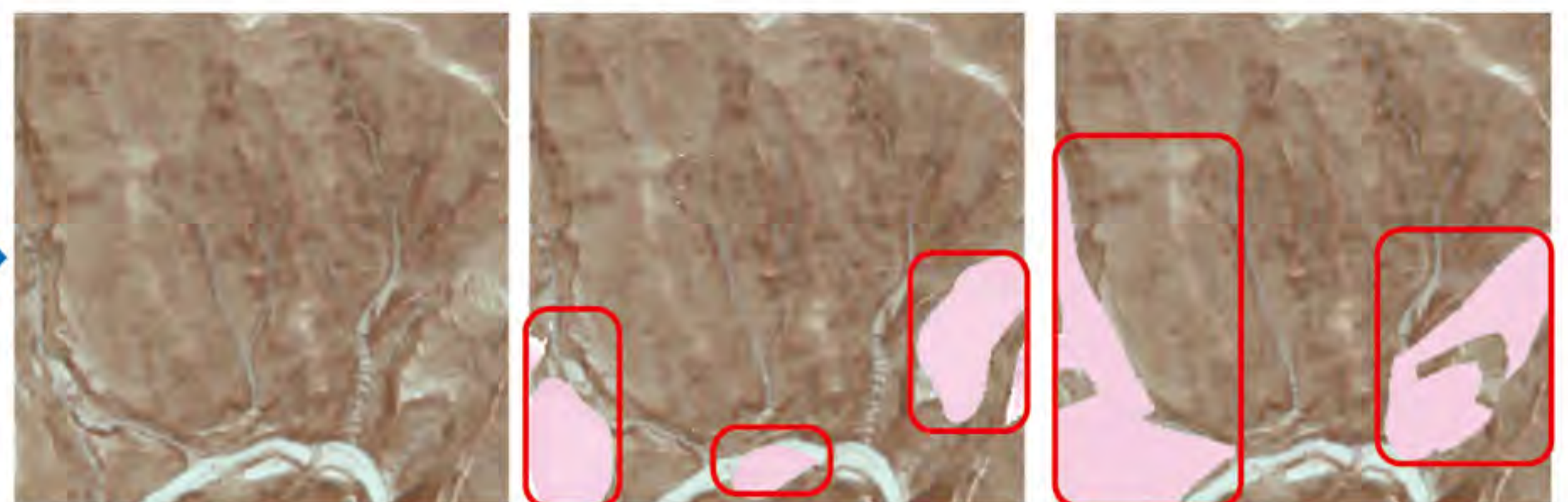
Extracción de topografía de deslizamientos de tierra mediante IA
