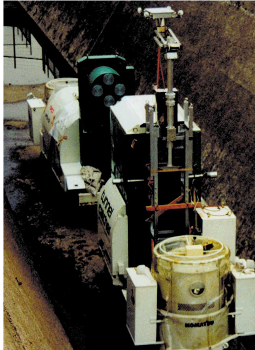
トンネルレーザ・レーダ計測システム 東京電力と共同で開発し、運転中
