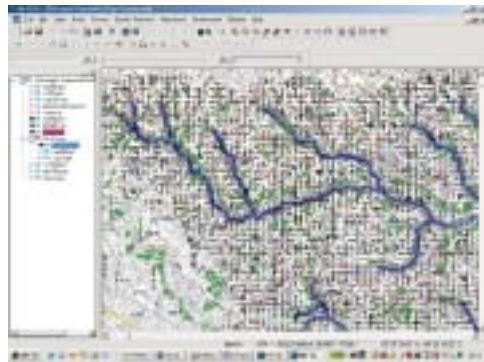
グリッド型流出解析に欠かせない地表面の勾配の向きを自動的に生成します
