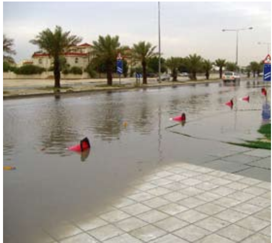
もともと雨が少ないドーハでは、雨水を排水する施設が整っていません。いったん雨が降ると道路はすぐに冠水してしまいます。
