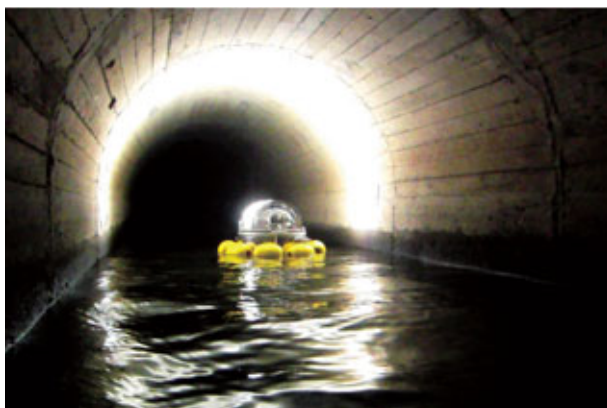
流下する無人点検ロボット(モモタロウ) (中国四国農政局 四国土改良調査管理事務所 2013年)
