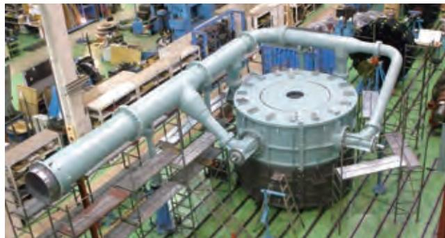
工場にて組み立て中の立軸ペルトン水車
