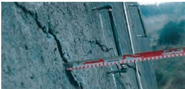
クラックゲージは、コンクリート構造物や岩盤に発生した亀裂の変位量を簡単に測定する目的で開発されました。
